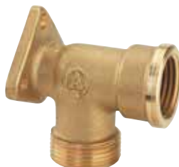
Raccordo curvo femmina flangiato in ottone giallo. Attacco tubo rame, plastica e multistrato.
