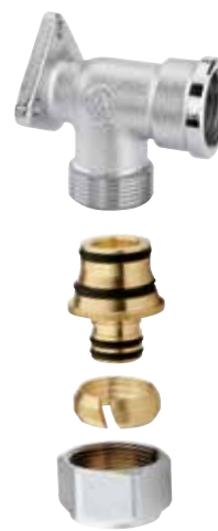
Raccordo curvo F flangiato per tubo multistrato in ottone cromato.
