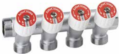
Collettore M/F 3/4" a quattro derivazioni con arresti, filetto 24x19. Attacco tubo rame, plastica e multistrato.
